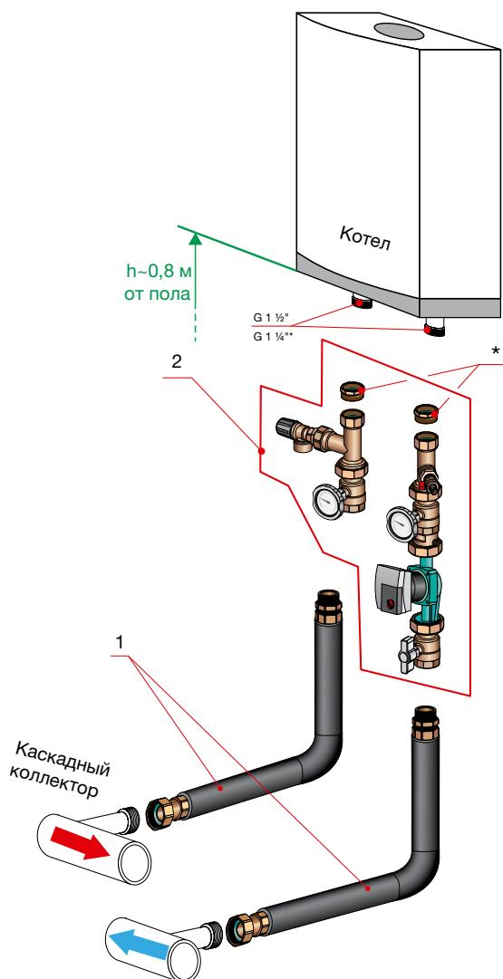
Обычно настенные конденсационные котлы мощностью 80-100 кВт нуждаются в подключении внешнего циркуляционного насоса и предохранительного клапана. Для решения этой задачи, Meibes предлагает следующий пример решения:
